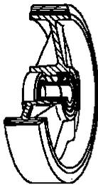
**Rivestimento:** in poliuretano iniettato, durezza 55 Shore D, ottime caratteristiche di scorrevolezza ed elasticità, buona resistenza ad usura e lacerazione.
