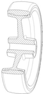
**Rivestimento:** in poliuretano iniettato, durezza 55 Shore D, ottime caratteristiche di scorrevolezza ed elasticità, buona resistenza ad usura e lacerazione.
