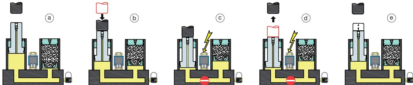
Das gesteuerte Gasdruckfegersystem kann, wie jede andere Gasdruckfeder, sowohl als autonom gefülltes System, als auch mit einer Kontrollarmatur versehen zum Einsatz kommen. Die Kontrollarmatur erlaubt die Einstellung des Fülldruckes (Kraft) von einem anderen Punkt. Angebracht an der Werkzeugaußenseite, kann somit die Kraft im Werkzeug eingestellt werden.
