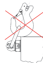
Abb. 5: Verbotene An- bzw. Auflage an Kanten
