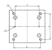
Der Ausgleichsblock wird mit Schrauben und Passstiften zur Befestigung auf dem Führungswagen geliefert.
