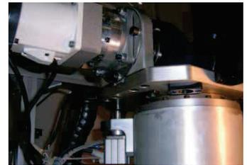
Das iglidur® Rundtischlager PRT-01-100 wird in dieser Anwendung in einer automatischen Schweißanlage eingesetzt. Es ermöglicht den Schwenk in der horizontalen Ebene der Spannvorrichtung.
