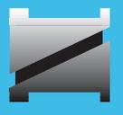
Die Clipslager sind seitlich schräg geschlitzt, wodurch die Montage der Gleitlager von einer Seite ermöglicht wird. Nach der Montage spreizt sich das Lager und kleidet die Bohrung im Blech aus. Durch die Welle wird verhindert, dass sich das Clipslager aus der Bohrung löst. Selbst bei axialen Bewegungen kann das Gleitlager nicht aus der Bohrung rutschen.
