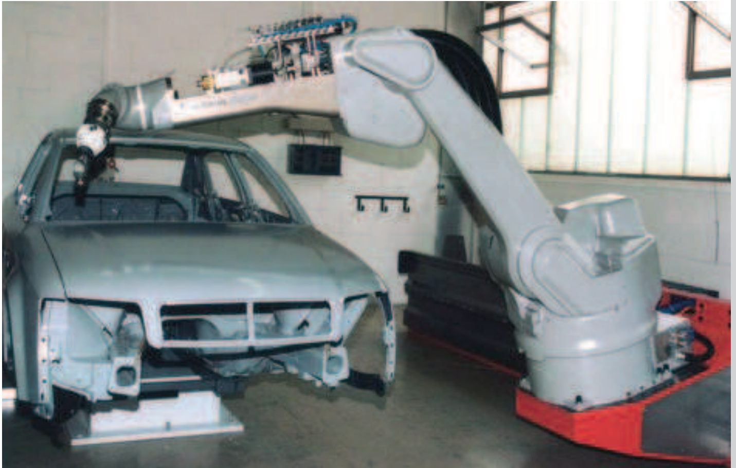
Lackierroboter mit System E4 E-Ketten® als ATEX-Version in ESD-Ausführung. Hohe Beschleunigungen bis zu 6 \text{ m/s}^2 und Bremsleistungen bei einem Gewicht des Roboters von ca. einer Tonne
