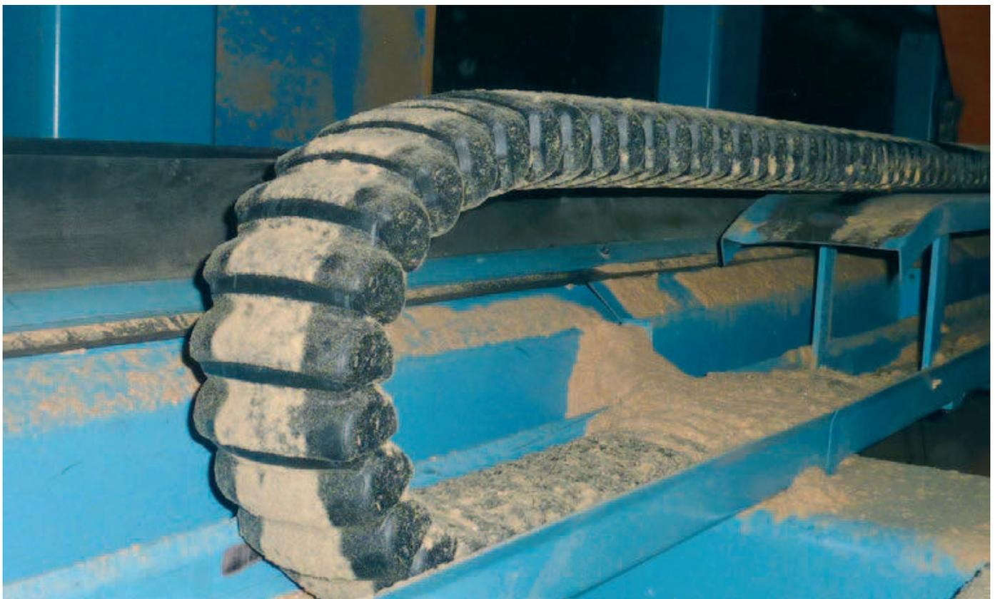
Mit dem extrem dichten igus® e-rohr RX und den darin verlegten chainflex®-Leitungen konnten die Standzeiten dieser Anlage erheblich gesteigert werden. Vorherige Leitungen fielen meist bereits nach einem Monat aus, bedingt durch Schmutz und Holzstaub sowie Leitungsstreß durch kleine Biegeradien
