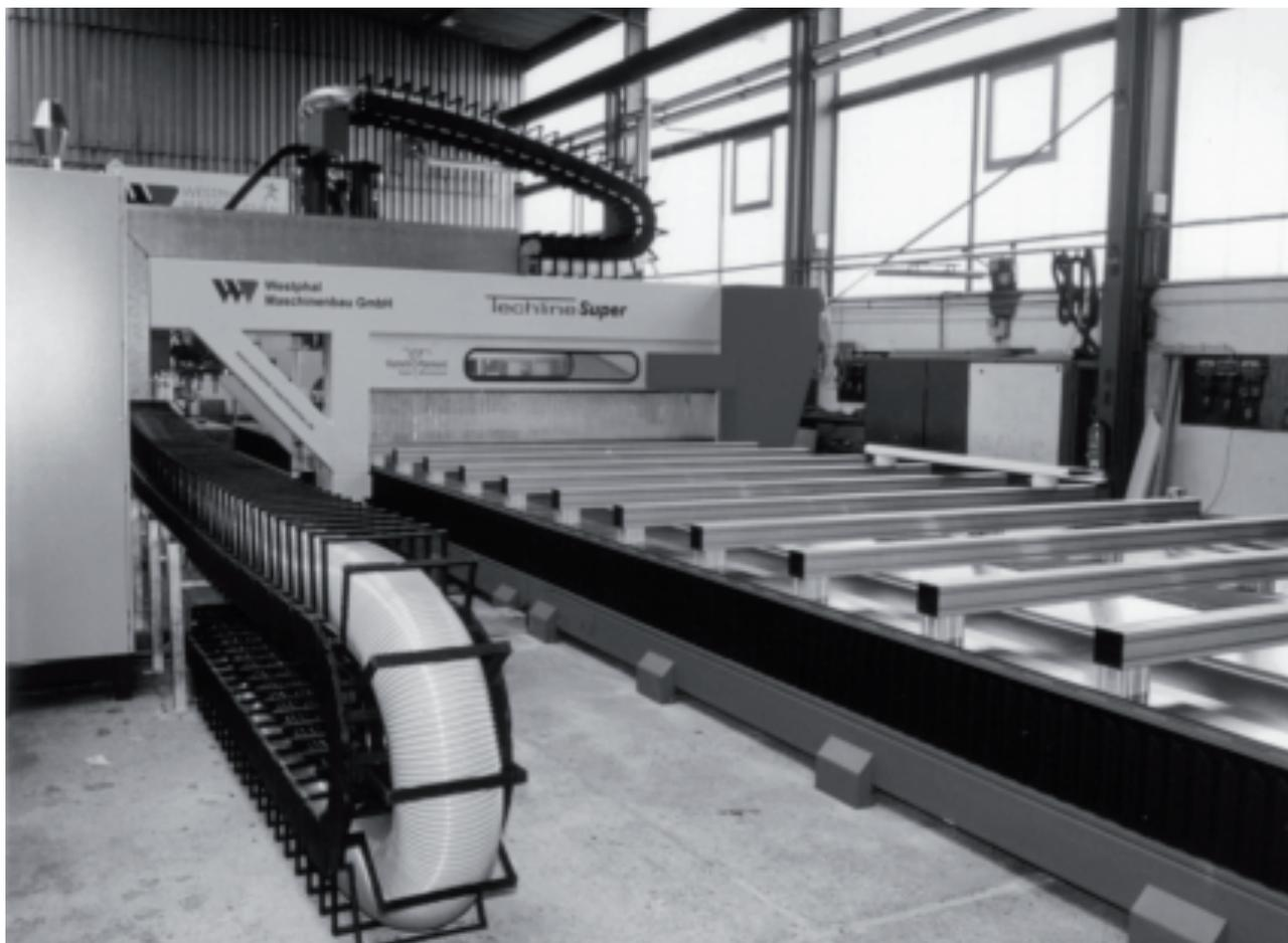
igus® Bügel E-Kette® an einer Holzbearbeitungsmaschine zur sicheren Führung eines großen Absaugeschlauches
