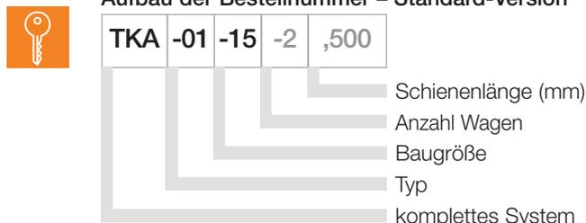
Dieses Bestellbeispiel (TKA-01-15-2, 500) bezieht sich auf ein komplettes DryLin® T-Automatik-System, Baugröße 15, mit 2 Wagen und einer Schienenlänge von 500 mm.
