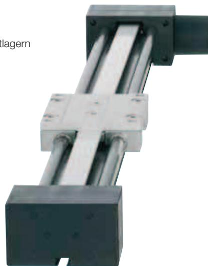
Die Verwendung von Polymer-Gleitlagern an allen beweglichen Teilen macht die Zahnriemenachse zu 100 % wartungs- und schmiermittelfrei. Schmiermittelverzicht bedeutet gleichzeitig eine hohe Schmutz-unempfindlichkeit, da Schmutzpartikel nicht auf den bewegten Teilen gebunden werden. Die Achse bietet somit ein hohes Maß an Robustheit in vielen Anwendungen. Je nach Anwendungsgebiet und Anforderung kann man zwischen zwei Baureihen wählen:
