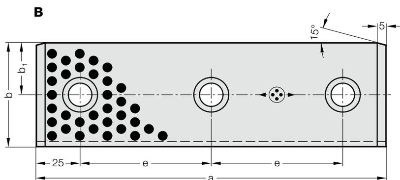
2962.75. Règle de guidage avec deux surfaces de glissement, Bronze avec lubrifiant solide, VDI 3357
