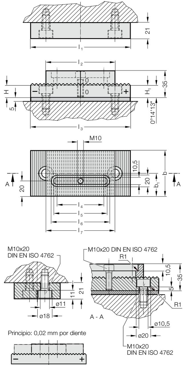
**2444.12 / 2444.13 Placa distanciamiento dentada, con placa de posicionado**
