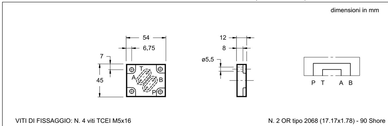
**4 - DIMENSIONI DI INGOMBRO E DI INSTALLAZIONE PE/D4-M (cod. 1950042)**
