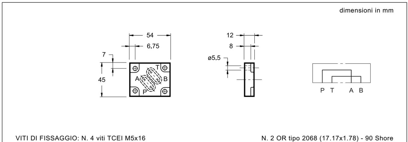
**3 - DIMENSIONI DI INGOMBRO E DI INSTALLAZIONE PE-C/PB/MD1/20 (cod. 1950601)**
