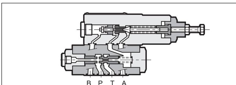
— La valvola MRQA è una valvola regolatrice di pressione con messa a scarico automatica. Al valore di taratura impostato la valvola mette in scarico libero la pompa e la rimette in pressione quando nel circuito si scende a valori di pressione corrispondenti al 75% o 63% del valore di taratura.
