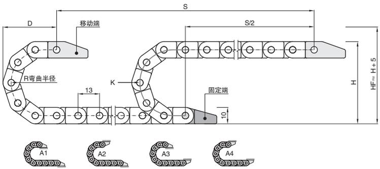
移动端, 固定端, R弯曲半径, S, S/2, D, H, HF=H+5, K, 13, 10
