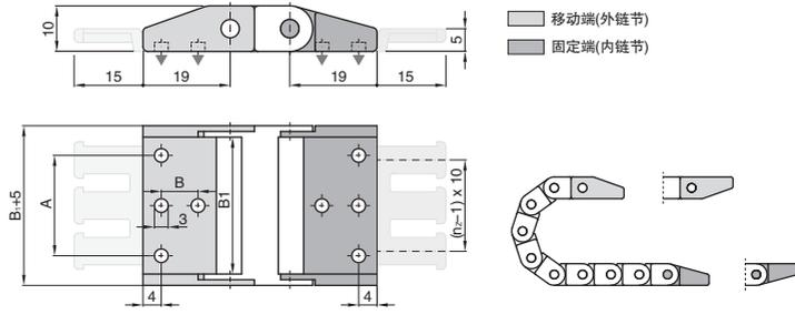
移动端(外链节), 固定端(内链节)
