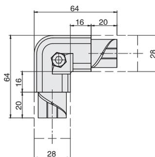
■ 产品特点：外观尺寸与精益管相同的半内置结构，适合使用于重视外观场合，其载荷性能比 AAJ28-A01 差。与 AAP28-06 配合使用可以设计看板及展示柜等。
