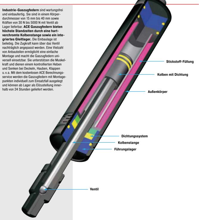
**Funktion:** ACE Industrie-Gaszugfedern sind wartungsfreie, in sich geschlossene Systeme, die mit einem unter Druck stehenden Stickstoff-Gas gefüllt sind. ACE Gaszugfedern arbeiten nach dem umgekehrten Prinzip der Gasdruckfedern. Durch den Gasdruck im Zylinder wird die
