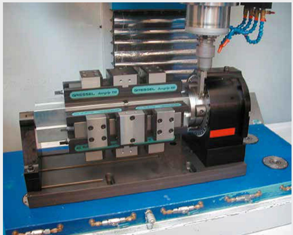
duogrip 125 duogrip 125 auf einer Spannbrücke (4. Achse) zur 3-Seitenbearbeitung duogrip 125 duogrip 125 on a 4 th axis 3-side machining
