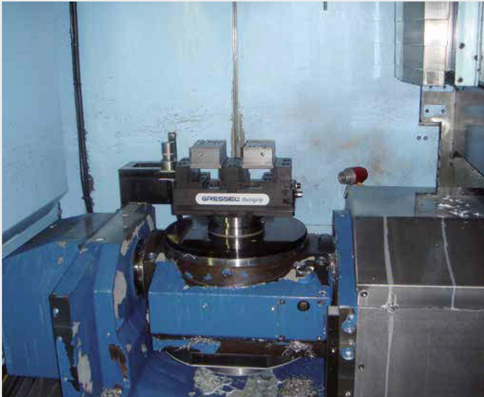
duogrip 100/270 duogrip 100 mit Grundkörperlänge 270 mm (Gesamtlänge 300 mm) auf einer Matsuura MAM72-3VS Maschine duogrip 100/270 duogrip 100 with base plate length of 270 mm (overall length 300 mm) on a Matsuura MAM72-3VS machine
