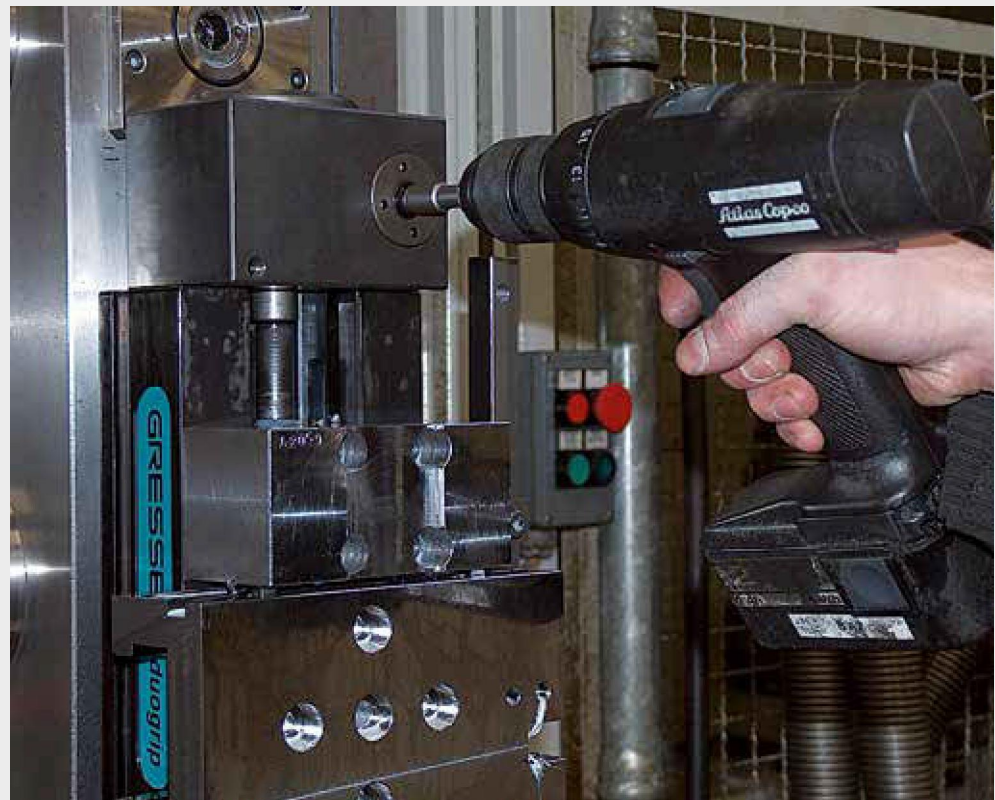
duogrip Winkeltrieb Spannen mit Akkuschauber (Schneckengetriebe Übersetzungsverhältnis 1:13). 30 kN mit 25 Nm duogrip angle drive Clamping using a cordless screwdriver (worm gear, transmission ratio 1:13). 30 kN at 25 Nm
