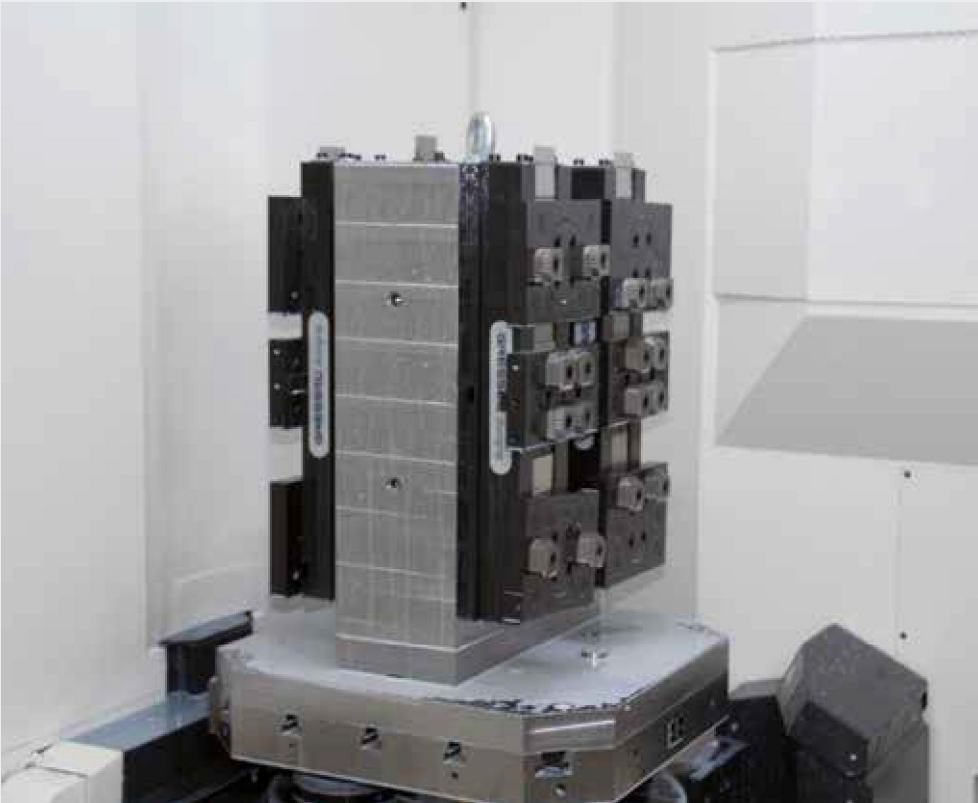
duogrip 125 Aufspannturm (Winkel) duogrip 125-R montiert an einem Doppelwinkel duogrip 125 tombstone (angle) duogrip 125-R installed on a double angle
