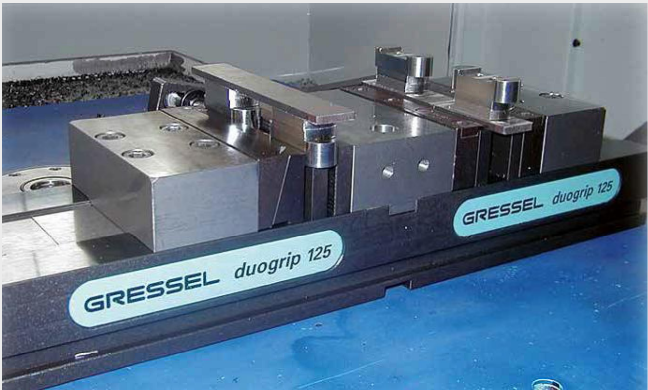
duogrip 125 1. Bearbeitung für knappe Einspannung mit Federblatt-Niederzugbacke, 2. Bearbeitung mit Niederzugbacke duogrip 125 1 st machining for close clamping using spring plate pull-down jaw, 2 nd machining using pull-down jaw
